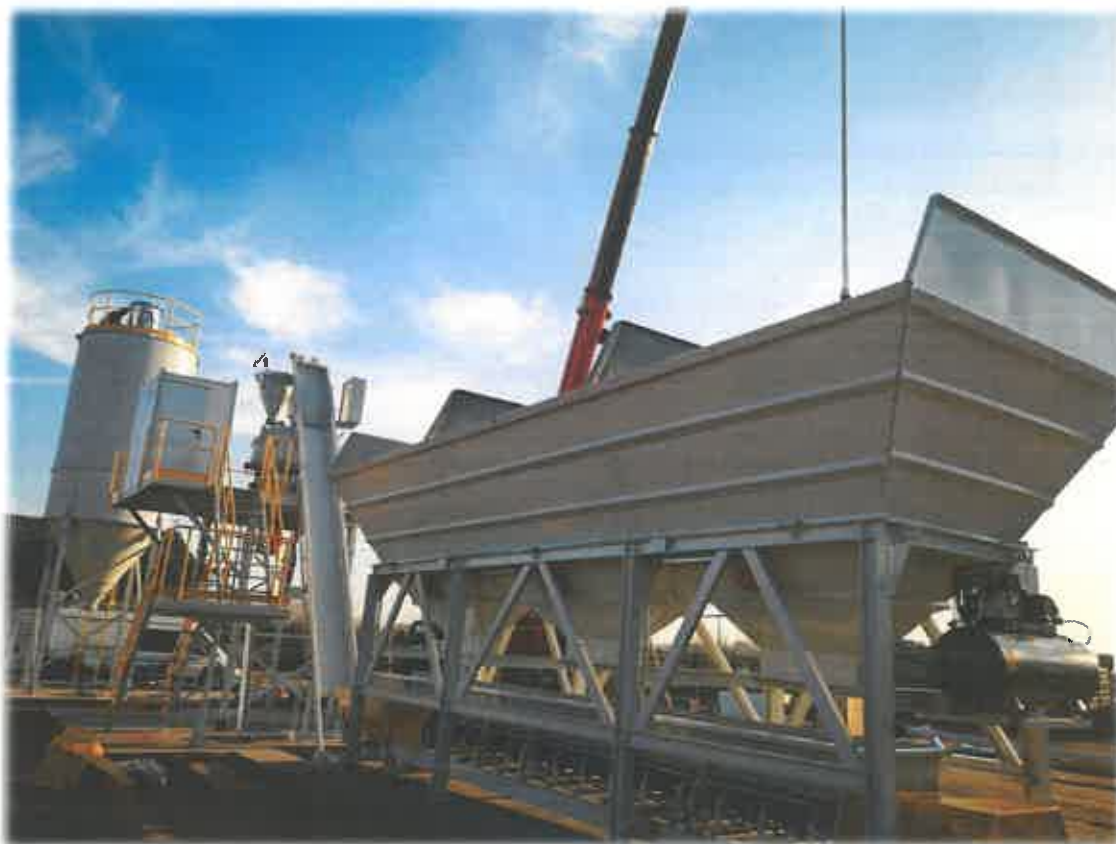
Zdjęcie 5. Węzeł do produkcji betonu
