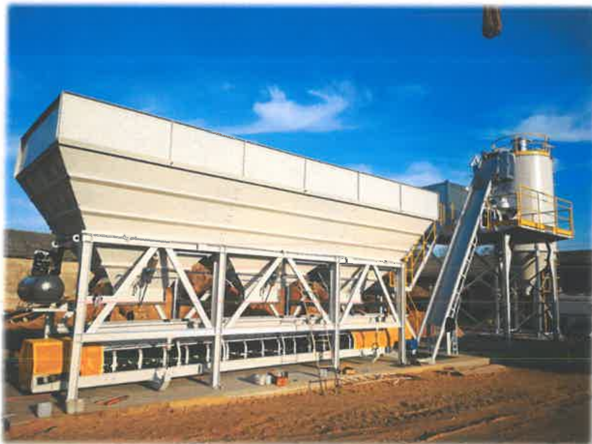
Zdjęcie 4. Węzeł do produkcji betonu
